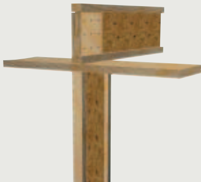
Stegverstärkung am Auflager
