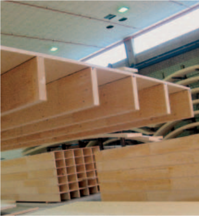
Fertig abgebundenes Rippenelement
